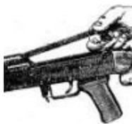
**6. Отделить возвратный механизм** – он похож на стержень, обмотанный пружинкой. Удерживая автомат левой рукой за шейку приклада, правой рукой подать вперед направляющий стержень возвратного механизма до выхода его пятки из продольного паза ствольной коробки; приподнять задний конец направляющего стержня и извлечь возвратный механизм из канала затворной рамы.
