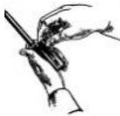
**8. Отсоединить затвор от затворной рамы.** Взять затворную раму с затвором в левую руку затвором кверху; правой рукой отвести затвор назад, повернуть его так, чтобы ведущий выступ затвора вышел из фигурного выреза затворной рамы, и вывести затвор вперед.
