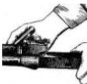
**9. Отделить газовую трубку со ствольной накладкой.** Удерживая автомат левой рукой, правой рукой повернуть замыкатель от себя до вертикального положения и снять газовую трубку с патрубком газовой камеры.
