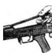
**6. Отделить возвратный механизм** – он похож на стержень, обмотанный пружинкой. Удерживая автомат левой рукой за шейку приклада, правой рукой подать вперед направляющий стержень возвратного механизма до выхода его пятки из продольного паза ствольной коробки; приподнять задний конец направляющего стержня и извлечь возвратный механизм из канала затворной рамы.
