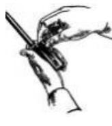
**8. Отсоединить затвор от затворной рамы.** Взять затворную раму с затвором в левую руку затвором вверху; правой рукой отвести затвор назад, повернуть его так, чтобы ведущий выступ затвора вышел из фигурного выреза затворной рамы, и вывести затвор вперед.
