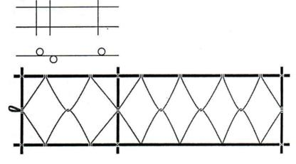
Рама носилок выполняется из двух продольных жердей длиной 2,5 м и трех поперечных длиной 0,7 м. Диаметр жердей 30-50мм. Расположение двух поперечин поверх продольных жердей, третья на расстоянии 20-50 см от головной поперечины (в сторону ног) снизу продольных жердей.
